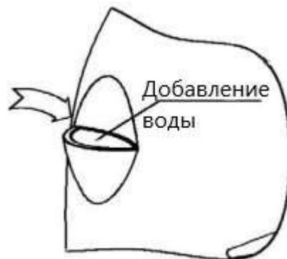
5. Добавьте чистящее средство через переднее заливное отверстие и заполните бак чистой водой. Если вы используете шланг для набора воды, вы можете вставить шланг непосредственно в отверстие для залива воды на боковой стороне машины. Обратите внимание на уровень воды, чтобы жидкость не переливалась через край.
